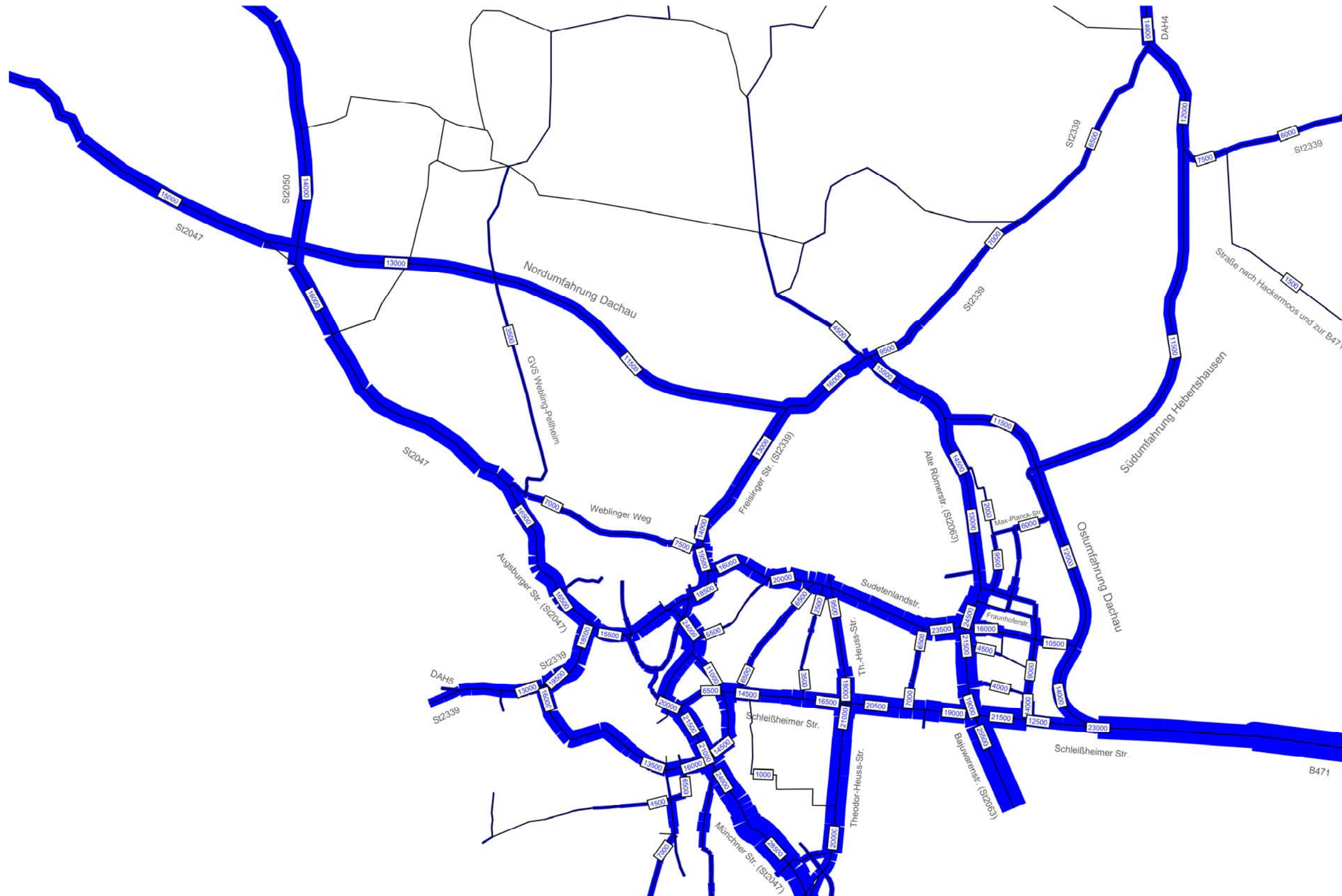
Abbildung 12 Verkehrsbelastungen erweiterter Planfall 2025 in [Kfz/24h] auf 500 gerundet
