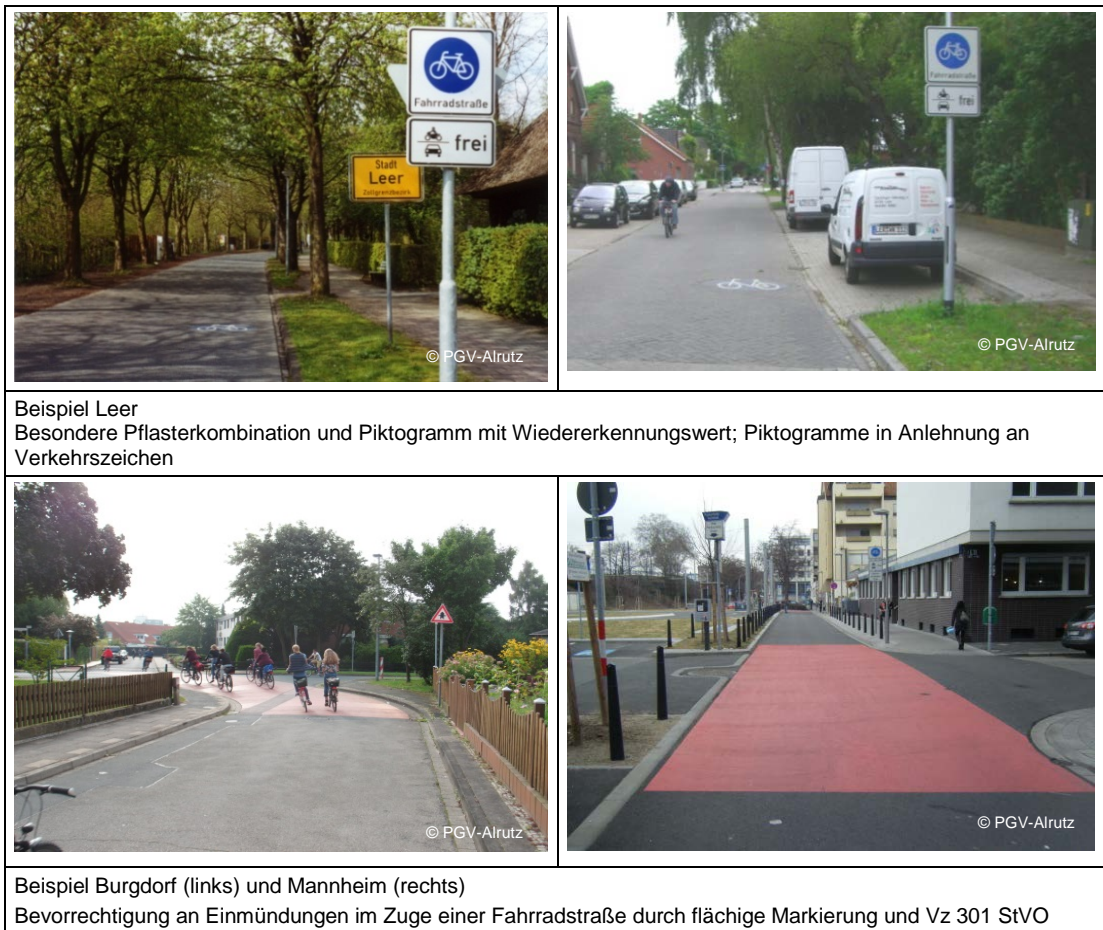
Abb. 5-5: Beispiele zur Ausgestaltung einer Fahrradstraße
