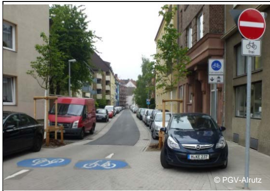
Beispiel Hannover Runde Piktogramme in Blau und Richtungspfeile im Straßenverlauf. Die Rinnen zwischen der asphaltierten Fahrbahn und den Parkständen sind farblich abgesetzt gepflastert und dienen als Sicherheitstrennstreifen.
